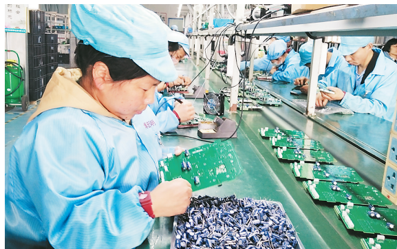
生产电路板的流水线上每个人负责一道工序
